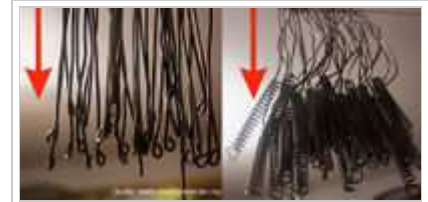
Feuercoaten äußere und innere Kondensatorteile, Coatingrichtung beachten und für den Zusammenbau merken! Quelle: www.Plasma-Energie.org
