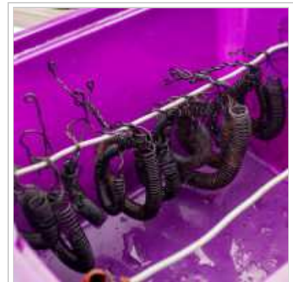
Vorbereitung zum Dampfcoating von Spulen (nicht für Magrav) Quelle: www.Plasma-Energie.org
