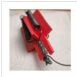
Kondensator 4er Kombination auf Gehäuse aufgesteckt. Quelle: www.Plasma-Energie.org
