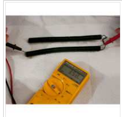
Polarisation einer Spule mit Multimeter, eingestellt auf Ohm Quelle: www.Plasma-Energie.org
