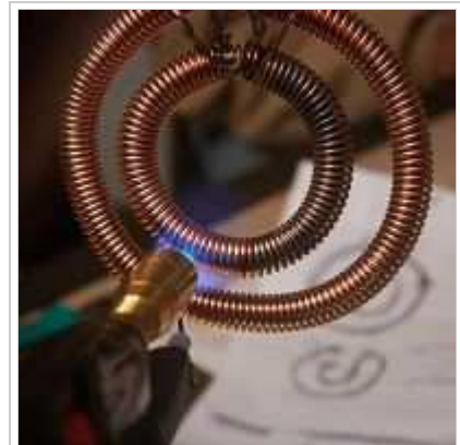
Feuercoaten der fix verdrahteten Spulen: Coatingrichtung beachten! Quelle: www.Plasma-Energie.org
